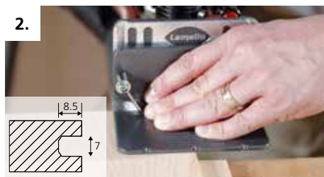
2. Mill a longitudinal groove
