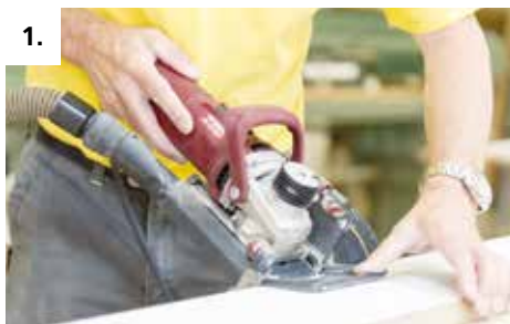
1. Mill a P-System groove
