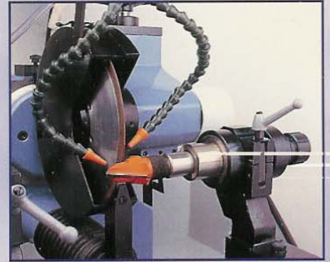
Profilatura punte da pantografo Routerbit profiling Affutage des meches de défonceuse Profilierung von Profilschaftfräsern
